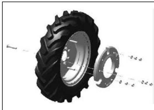
фиг. 181 - МОНТИРАНЕ НА БАЛАСТНА ТЕЖЕСТ КЪМ ЗАДНОТО КОЛЕЛО
