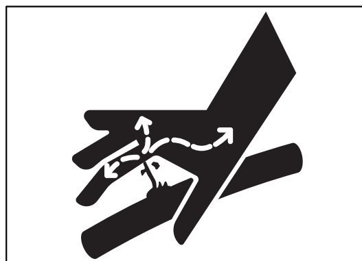
фиг. 45 - ТЕЧНОСТ ПОД ВИСОКО НАЛЯГАНЕ - ИНЖЕКТИРАНЕ В ТЯЛОТО
