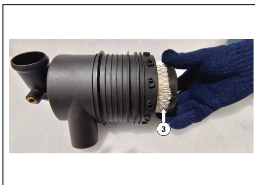
фиг. 155 - СВАЛЯНЕ НА ПЪРВИЧНИЯ ФИЛТЪР
