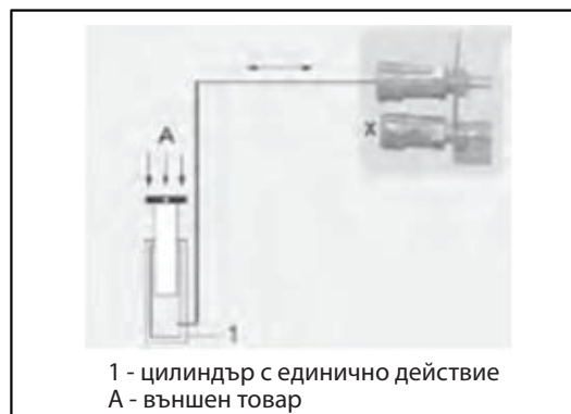
фиг. 111 - ЦИЛИНДЪР С ЕДИНИЧНО ДЕЙСТВИЕ
