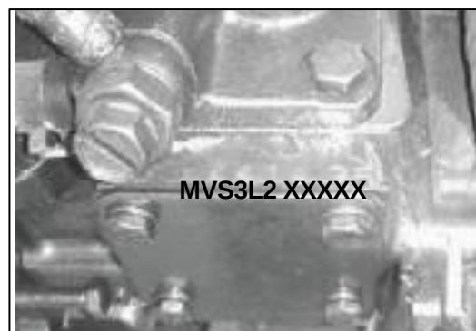
Фиг. 5 – МЯСТО НА СЕРИЙНИЯ НОМЕР НА ДВИГАТЕЛЯ
