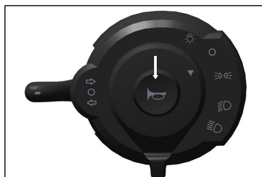
Фиг. 84 – ПРЕВКЛЮЧВАТЕЛ ЗА КЛАКСОНА
