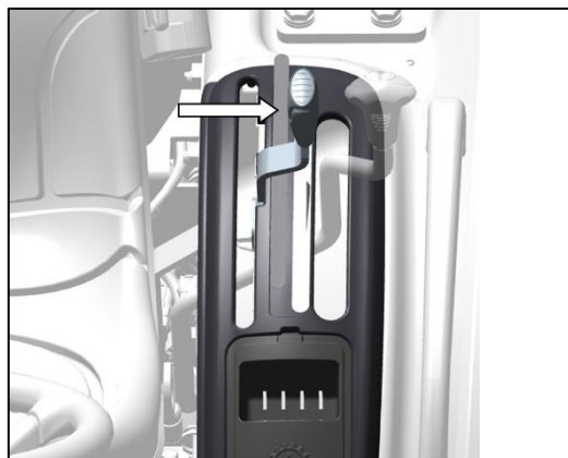
Фиг. 103 – ДВУСКОРОСТЕН ВОМ
