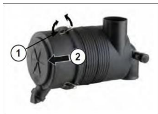
Фиг. 163 – СВАЛЯНЕ НА ДОЛНАТА СЕКЦИЯ НА КОРПУСА
