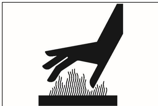
Фиг. 50 – ГОРЕЩИ ПОВЪРХНОСТИ – ОПАСНОСТ ОТ ИЗГЪРЯНЕ НА ПРЪСТИТЕ ИЛИ РЪЦЕТЕ
