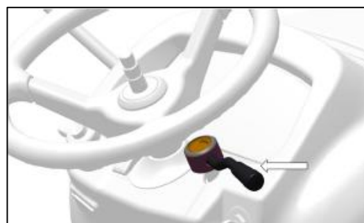
Фиг. 88 – ЛОСТ ЗА РЪЧНА ГАЗ
