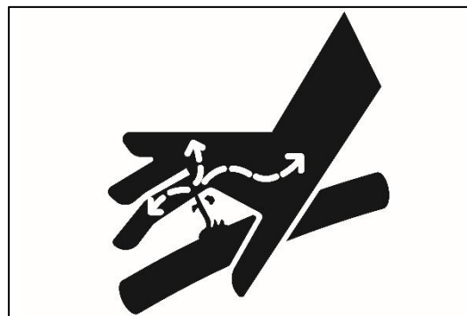
Фиг. 45 – ТЕЧНОСТ ПОД ВИСОКО НАЛЯГАНЕ – ИНЖЕКТИРАНЕ В ТЯЛОТО
