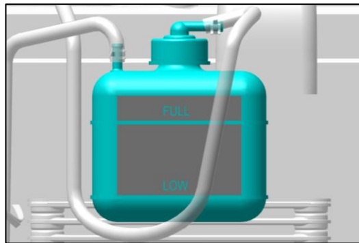
Фиг. 167 – ПРЕЛИВЕН РЕЗЕРВОАР ЗА ОХЛАЖДАЩА ТЕЧНОСТ
