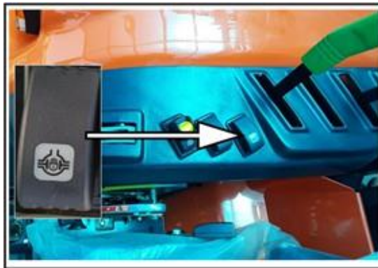
Фиг. 80 – МЕСТОПОЛОЖЕНИЕ НА БЛОКАЖА НА ДИФЕРЕНЦИАЛА
