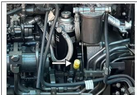
Фиг. 145 б – ЩЕКА ЗА ПРОВЕРКА НА НИВОТО НА МАСЛОТО
