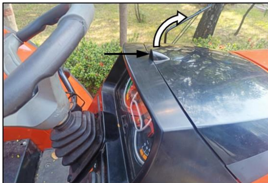
Фиг. 163 a – МЯСТО НА СПИРАЧНИЯ РЕЗЕРВОАР
