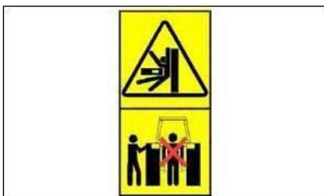
Фиг. 46 ж – ОПАСНОСТ ОТ СМАЧКВАНЕ НА ТЯЛОТО
