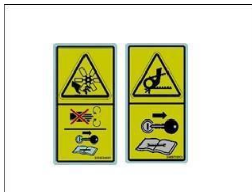
Фиг. 46 в – ОПАСНОСТ ОТ ОТРЯЗВАНЕ НА ПРЪСТИТЕ ИЛИ РЪКАТА – ВЕНТИЛАТОР НА ДВИГАТЕЛЯ
