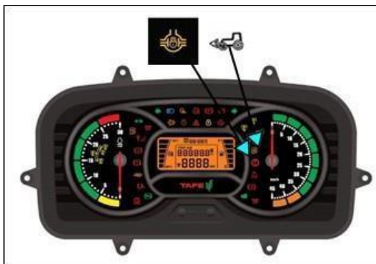
Фиг. 81 – ИНДИКАТОР ЗА БЛОКАЖА НА ДИФЕРЕНЦИАЛА НА АРМАТУРНОТО ТАБЛО
