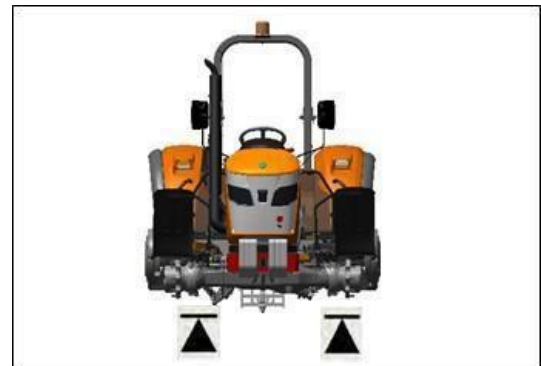
Фиг. 31 е – ТОЧКИ ЗА ПОВДИГАНЕ НА КРИК
