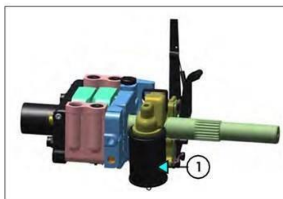
Фиг. 168 – СМУКАТЕЛНА ЦЕДКА НА ХИДРАВЛИЧНАТА ПОМПА
