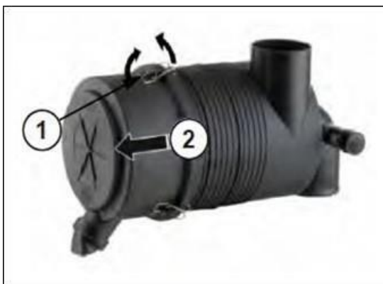
Фиг. 151 – СВАЛЯНЕ НА ДОЛНАТА ЧАСТ НА КОРПУСА
