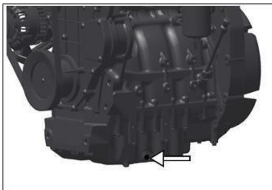
Фиг. 146 – ПРОБКА ЗА ИЗТОЧВАНЕ НА МАСЛОТО ОТ ДВИГАТЕЛЯ
