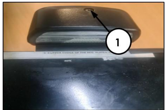
Фиг. 207 б – СВАЛЯНЕ НА СТЬКЛОТО НА ОСВЕТИТЕЛЯ НА РЕГИСТРАЦИОННАТА ТАБЕЛА
