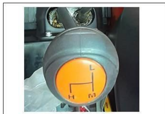
Фиг. 64 – ЛОСТ ЗА ИЗБОР НА ВИСОК И НИСЪК ДИАПАЗОН
