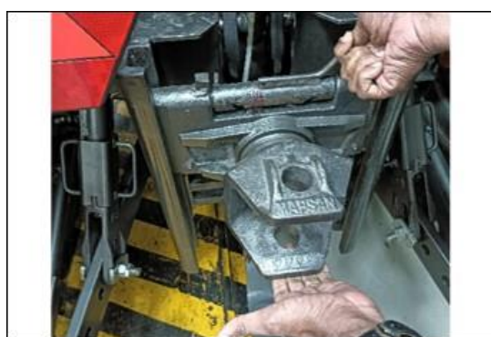
Фиг. 120 e – ЗАКЛЮЧВАНЕ НА ЗАДНИЯ ТЕГЛИЧ СЛЕД ЗАДАВАНЕ НА НЕОБХОДИМАТА ПОЗИЦИЯ
