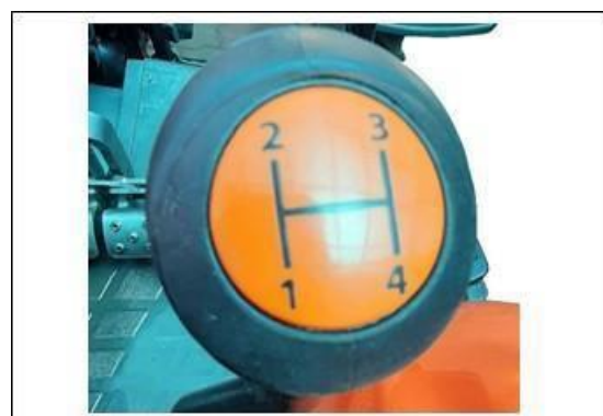
Фиг. 65 – ЛОСТ ЗА ПРЕВКЛЮЧВАНЕ НА ОСНОВНИТЕ ПРЕДАВКИ
