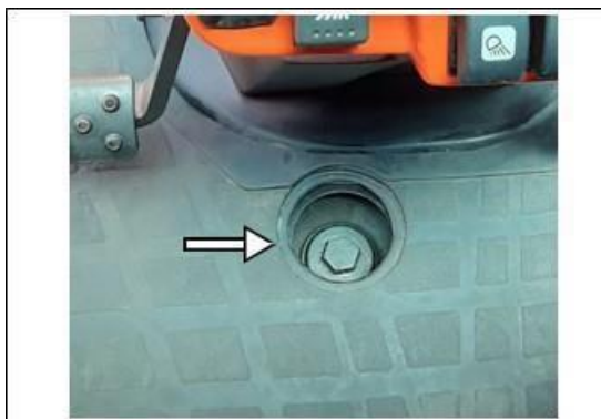
Фиг. 166 – МЯСТО НА ПЪЛНЕНЕ И ПРОБКА ЗА ПЪЛНЕНЕ НА ТРАНСМИСИОННО МАСЛО
