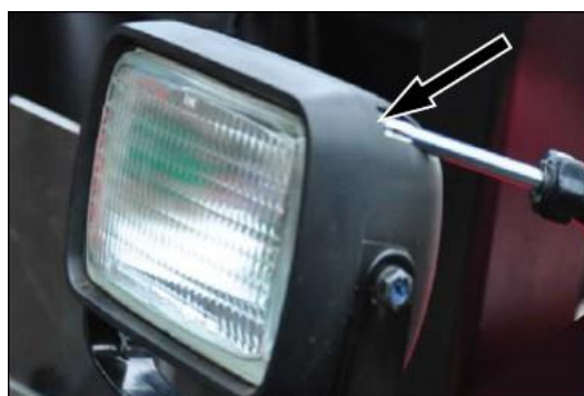
Фиг. 209 б – СВАЛЯНЕ НА МОНТАЖНИТЕ ВИНТОВЕ
