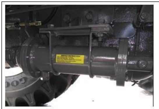
Фиг. 171 – ДЕМОНТИРАНЕ НА СМУКАТЕЛНИЯ ФИЛТЪР
