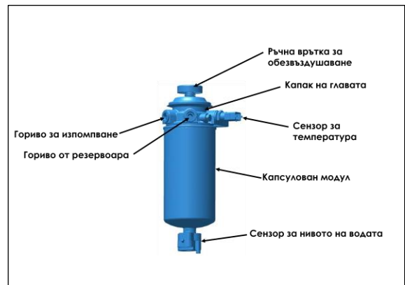
Фиг. 148 с – ОБЕЗВЪЗДУШАВАНЕ НА ГОРИВНИЯ ФИЛТЪР
