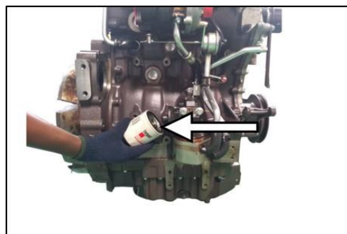
Фиг. 147 б – СМАЗВАНЕ НА УПЛЪТНЕНИЕТО НА КОРПУСА
