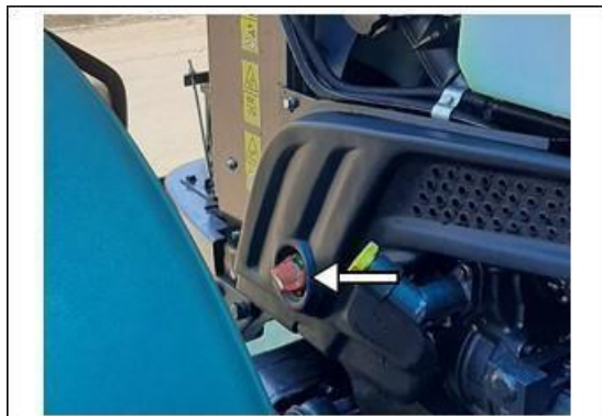
Фиг. 197 – ПОЗИЦИЯ НА ПРЕКЪСВАЧА НА АКУМУЛАТОРА
