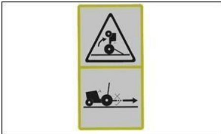
Фиг. 46 й – ОПАСНОСТ ОТ ПРЕОБРЪЩАНЕ ОТЗАД – РИСК ОТ СМАЧКВАНЕ
