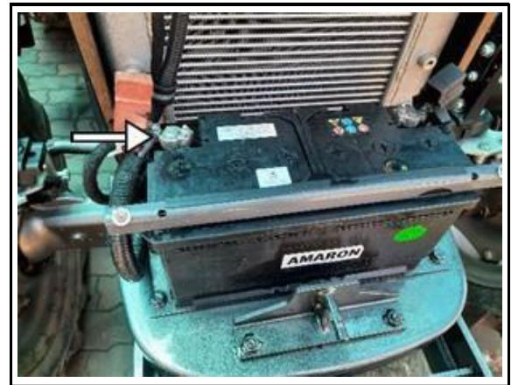
Фиг. 196 – МЯСТО НА АКУМУЛАТОРА И ВРЪЗКАТА ЗА ОТРИЦАТЕЛНИЯ КАБЕЛ
