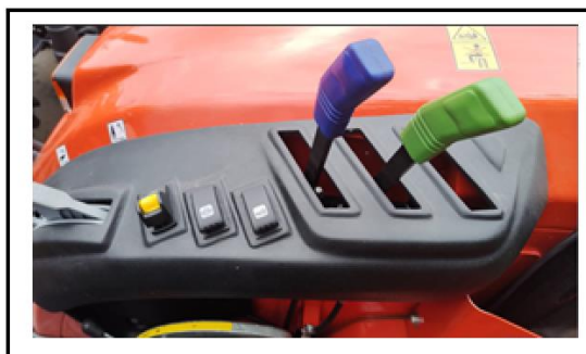
Фиг. 126 – ПОЗИЦИЯ НА ЛОСТА ЗА СПОМАГАТЕЛНАТА ХИДРАВЛИКА
