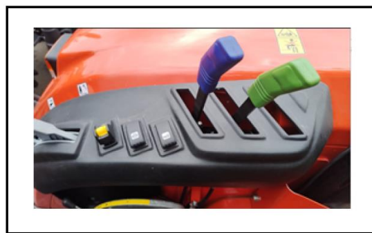
Фиг. 121 – СПОМАГАТЕЛНА ХИДРАВЛИЧНА СИСТЕМА – ЛОСТ ЗА УПРАВЛЕНИЕ
