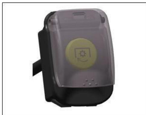
Фиг. 56 – СТАЦИОНАРЕН ПРЕВКЛЮЧВАТЕЛ ЗА ВОМ
