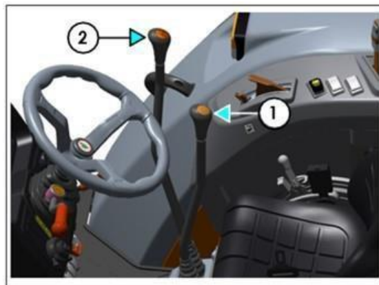
Фиг. 63 – МЕСТОПОЛОЖЕНИЕ НА ЛОСТА ЗА ДИАПАЗОНА И ЛОСТА ЗА ПРЕВКЛЮЧВАНЕ НА ПРЕДАВКИТЕ
