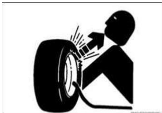
Фиг. 43 – ОПАСНОСТ ОТ ПРЕКОМЕРНО НАДУВАНЕ
