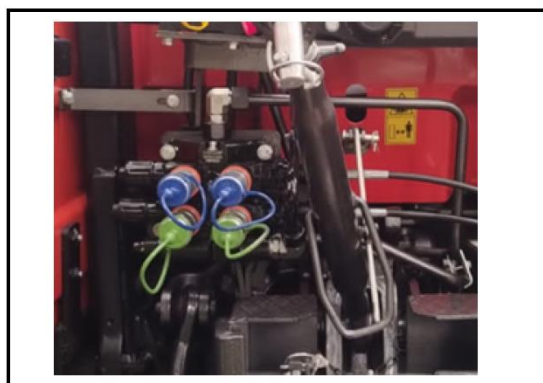
Фиг. 122 – СПОМАГАТЕЛНА ХИДРАВЛИЧНА СИСТЕМА – ШПУЛЕН КЛАПАН
