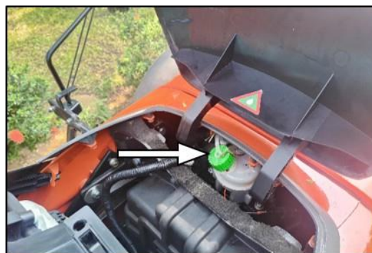
Фиг. 163 b – МЯСТО НА СПИРАЧНИЯ РЕЗЕРВОАР
