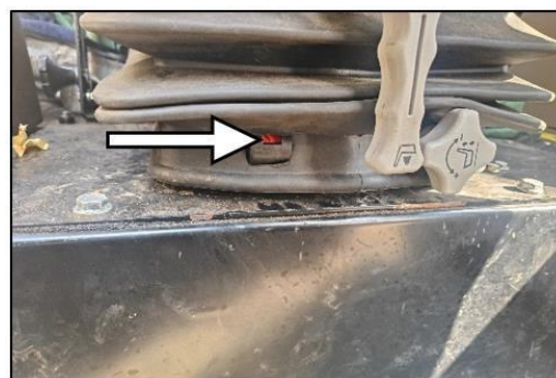
Фиг. 88 б – РЕГУЛИРАНЕ НА ТЕГЛОТО НА СЕДАЛКАТА НА ОПЕРАТОРА – ЧЕРВЕН ЦВЯТ
