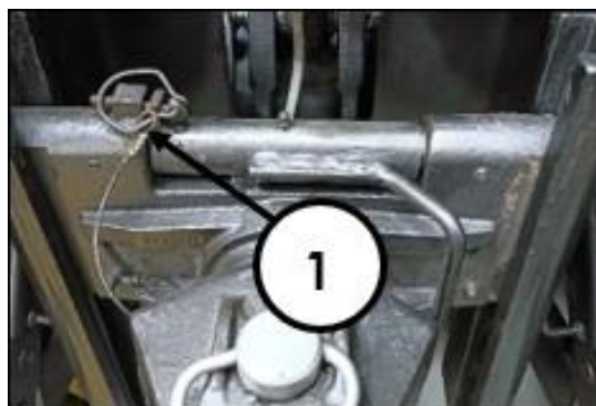
Фиг. 120 с – СВАЛЯНЕ НА ЩИФТА С ХАЛКА
