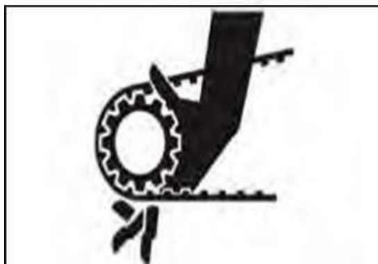
Фиг. 32 б – ОПАСНОСТ ОТ ЗАПЛИТАНЕ НА РЪЦЕТЕ И РАМЕНЕТЕ ПРИ ЗАДВИЖВАНЕ С ВЕРИГА ИЛИ ЗЪБЕН РЕМЪК
