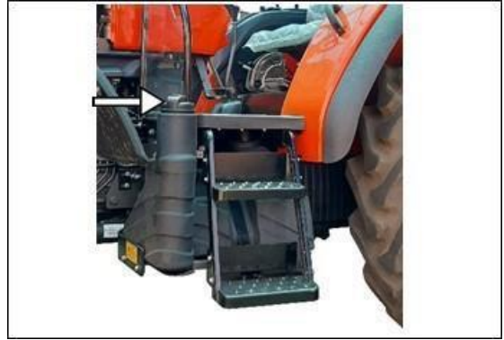
Фиг. 131 – РЕЗЕРВОАР ЗА ГОРИВО И КАПАЧКА НА ГЪРЛОВИНАТА ЗА ГОРИВО
